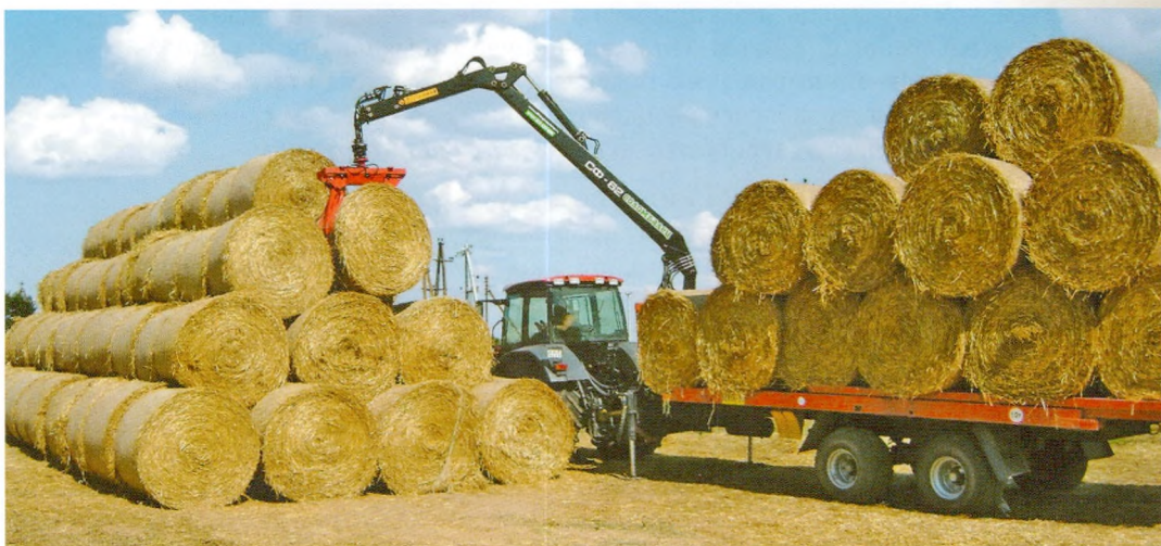
■ Платформа з маніпулятарам для падбору, самапагрузкі і транспарціроўкі кармоў і лёну, запрэсаваных у рулоны або цюкі, з механізаванай разгрузкай штабеляваннем у месцы складвання
