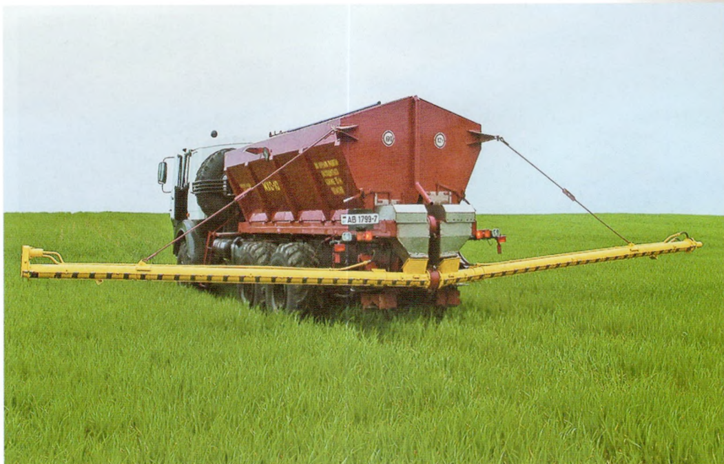
■ Самаходная машына хімізацыі МХС-10. Прызначана для транспартавання і паверхневага ўнясення пылападобных хімічных меліярантаў і цвёрдых мінеральных угнаенняў
