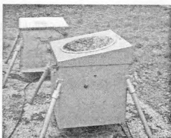
Рис. 7.2. Імпульсныя вымяральнікі ніжняй мяжы воблакаў: IBB-1М на заднім плане, сучасны IBB-2 – на перэднім
