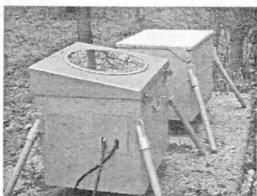
Рис. 7.2. Імпульсныя вымяральнікі ніжняй мяжы воблакаў: IBB-1М на заднім плане, сучасны IBB-2 – на перэднім
