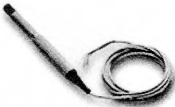
Рыс. 11.22. Вымяральнік тэмпературы і адноснай вільготнасці паветра НМР45D
