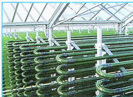
Мал. 40. Устаноўка для вырошчвання хларэлы
