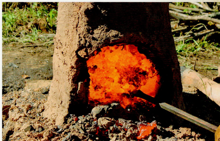
Плаўка жалезнай руды ў печы- домніцы. Сучасная рэканструкцыя.
