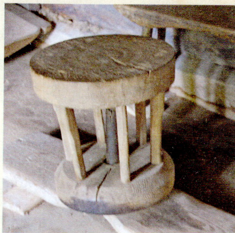
Ціаходны нажны ганчарны круг. Пачатак XX ст. БДМНАП.
